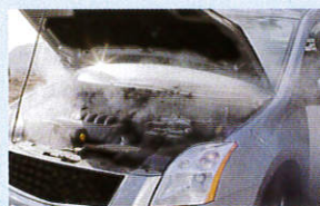
冷却不良によるオーバーヒート
