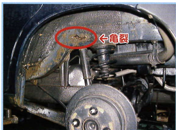
凍結防止剤の付着等により、フレームの腐食が進み、亀裂が生じてしまった状態
