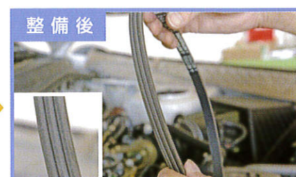
補機ベルトが新品の状態 (写真は車両への取付前の状態)
