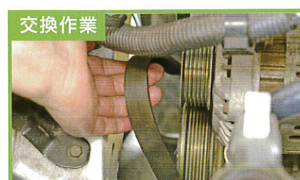
補機ベルトをエンジンから取り外し中
